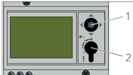
Abb. 23: Joystick und Schalter am Leistungsmessgerät WM10
